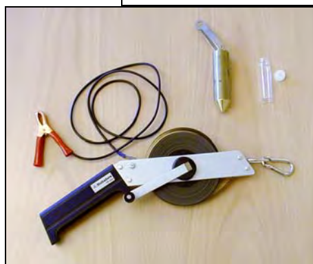
Dispositif de prélèvement d'échantillons avec un ruban de mesure en acier
